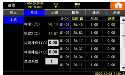
补偿是包含了冷端及每个通道的独立补偿，滤波系数范围为1-64，数据越大滤波深度越大，越稳定，但测量会越慢。对有干扰的场合上使用对应的滤波系数有助于测量数据的稳定。
