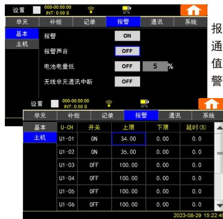
报警基本设置，包含了是否开通报警，报警时是否发出声音，是否开通电池电量报警，并能设置报警阈值，在无线单完通信中断时是否报警。
