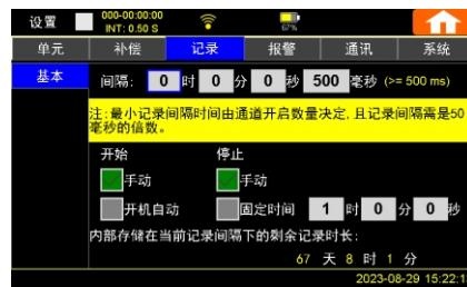
设置记录的间隔时间，最小记录间隔时间由通道开启数量决定，且记录间隔需50mS的倍数，最小记录间隔为0.1S/（2通道），每增加一路就加0.05秒。最大设置间隔时间为：2小时59分钟59秒950毫秒。
