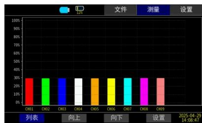
在曲线界面按显示键切换至柱图界面。柱图界面显示实时数据柱形图。
